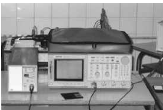
Figura 2: Izda.: foto del osciloscopio TDS 754. Dcha.: tensión, corriente y potencia de un motor.
